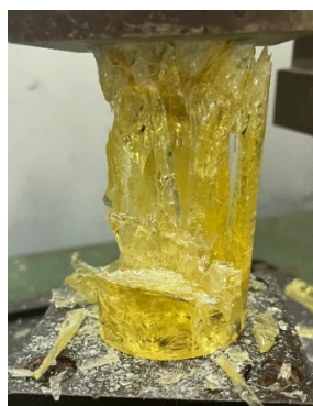
图4 脆性透明岩石相似材料破坏形态
